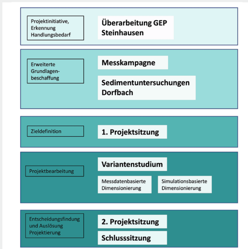
Fig. 10 Projektablauf Ausbau RÜB Sennweid.
